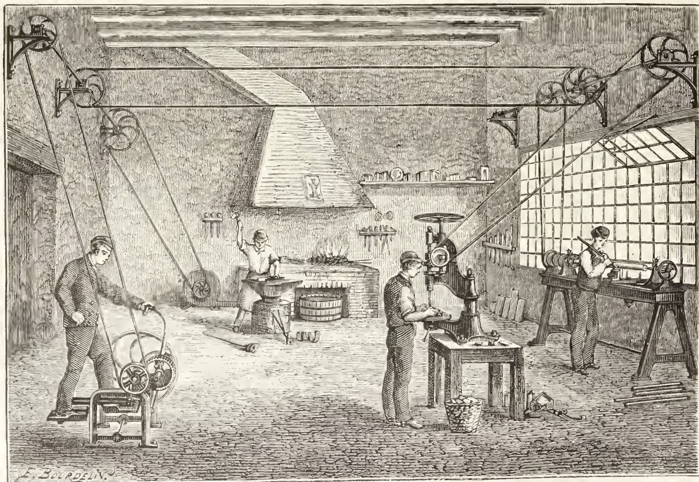
C. — UN'OFFICINA NELLA QUALE SI VEDONO LE DIFFERENTI APPLICAZIONI CHE SI POSSONO FARE DEL BAROMOTORE GASTONE BOZÉRIAN.
